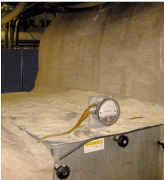
Støvet på billedet er durumhvedemel, der er meget groft. Eksplosionsrisikoen er minimal, men der skal gøres rent alligevel.
