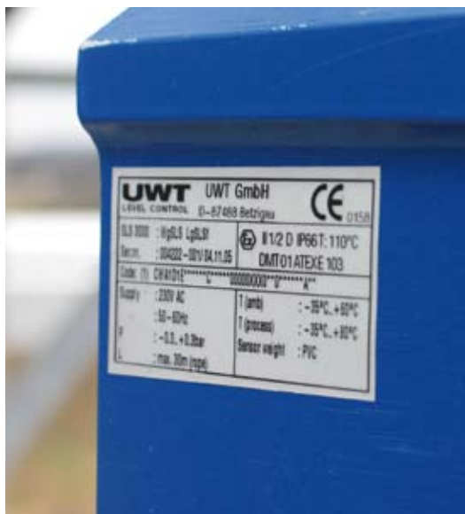
Ex-mærket niveaumåler til silo. Niveaumåleren er godkendt til at operere i zone 20 (materialkategori 1D).
